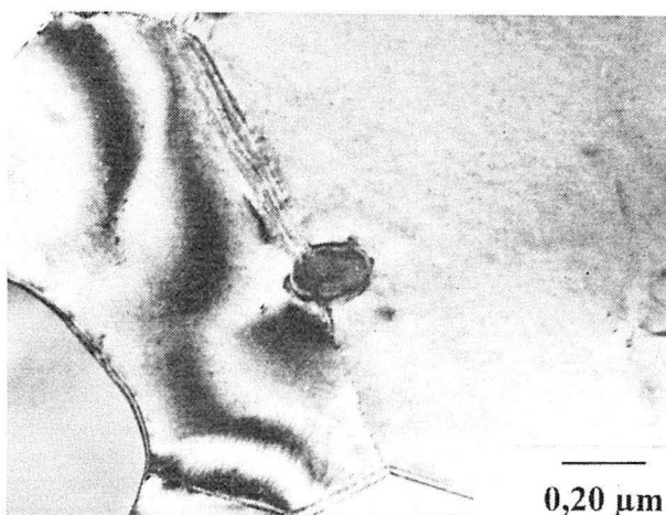
Figure 5.63 - MET (165/1, TT = 550°C/100h) : blocage d'un sous-joint par un précipité.
