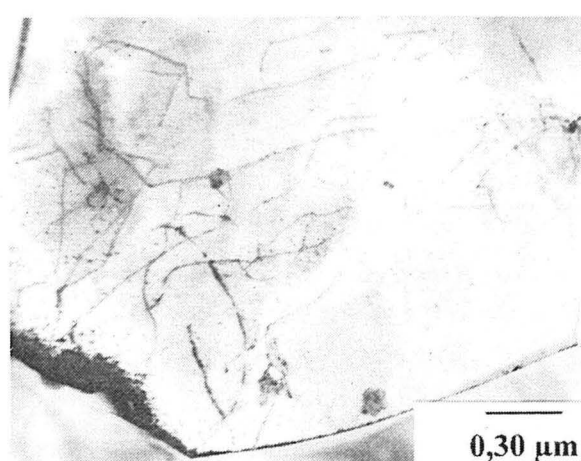
Figure 4.17 - Un maintien de 100 h à 300°C ne modifie pas apparemment la fraction volumique de précipités.
