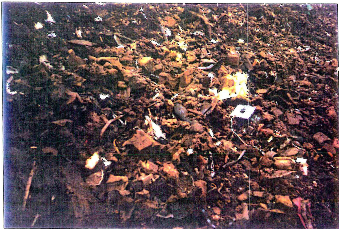
Photo 8 : RBA après broyage et aspiration des légers
