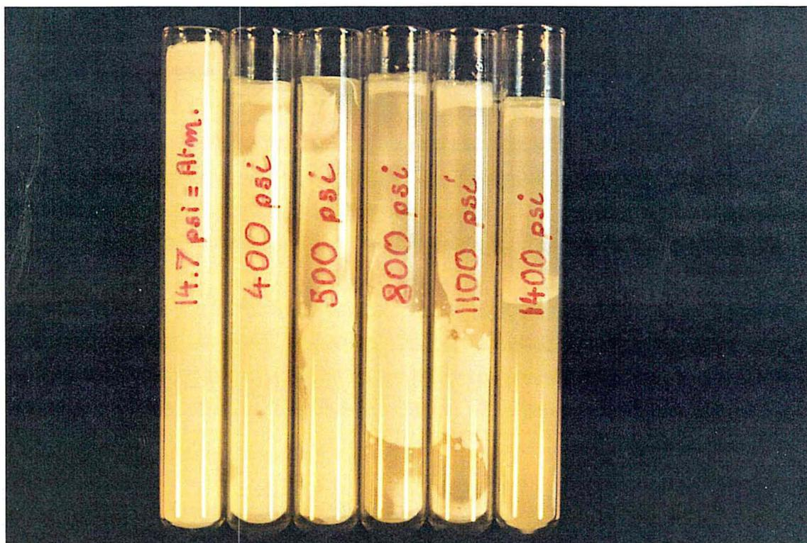
Figure III.14. Systèmes polymérisés sous pression.
