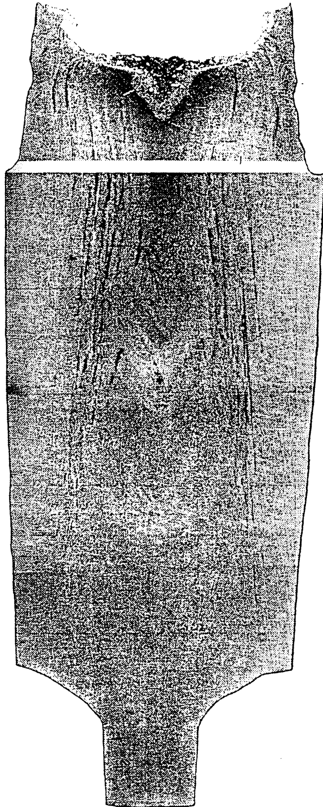
Figure I-6 empreinte Baumann d'un lingot de 35 tonnes en acier au carbone mi-dur masselotté coulé en chute sous vide (d'après [11])
