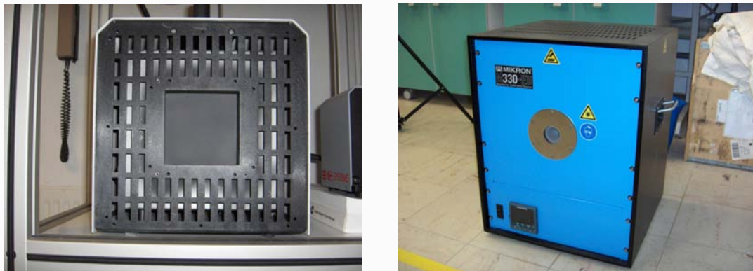
Figure 5.40 – Corps noirs utilisés pour l'étalonnage et la correction de non uniformité de la caméra. A gauche : Corps noir à large surface [20-600°C]. A droite : Corps noir à cavité [300-1700°C]
