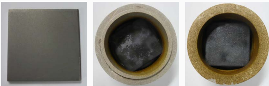
Figure 7.51 – Echantillon de Titane endommagé suite aux hautes températures (vers 1100 °C). A gauche : avant les expériences. Au centre et à droite : après les expériences
