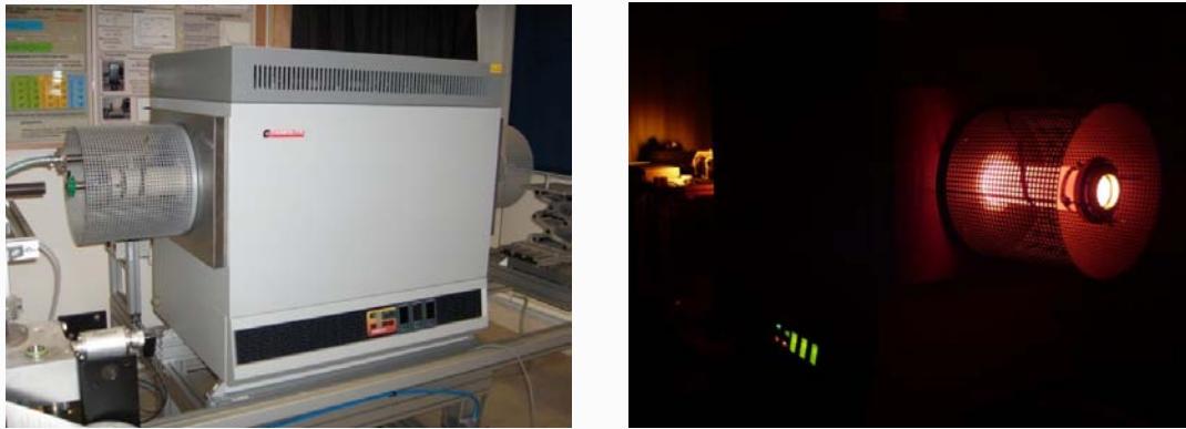
Figure 5.13 – Four Tubulaire Haute Température [20-1800 °C]
