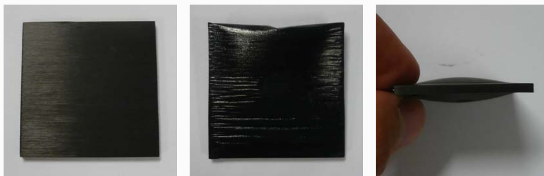
Figure 7.67 – Echantillon de Carbone endommagé suite aux hautes températures. A gauche : avant les expériences. Au centre et à droite : après les expériences
