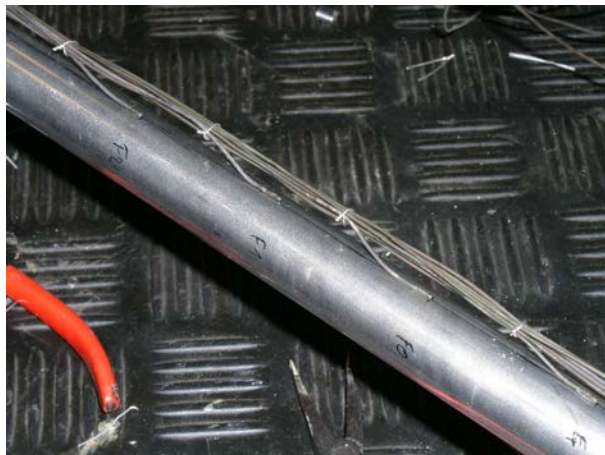
FIG. 4.5 – Thermocouples fixés sur la section d'essai
