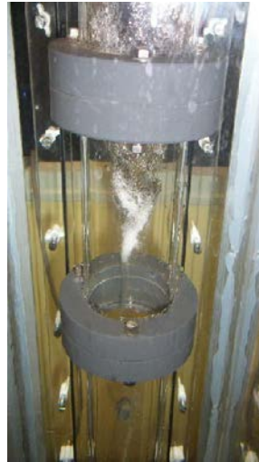
(b) Vortex creusé , Q_l = 4,53 \text{ m}^3/\text{h} ( V_{s,c,l} = 0,309 \text{ m/s} ), \dot{m}_g = 40 \text{ kg/h} ( V_{s,c,g} = 2,274 \text{ m/s} ). La première bride sur les photos (n'apparaît qu'à peine dans la seconde) se situe à 22 cm environ au-dessous du niveau de l'entrée. La distance entre les deux brides sur la photo est de 15 cm.
