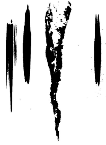
(b) Ajustement de la direction verticale et binarisation de la photo à l'aide de ImageJ.
