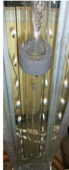
(b) Vortex creusé , Q_l = 4,53 \text{ m}^3/\text{h} ( V_{s,c,l} = 0,309 \text{ m/s} ), \dot{m}_g = 40 \text{ kg/h} ( V_{s,c,g} = 2,274 \text{ m/s} ). La première bride sur les photos (n'apparaît qu'à peine dans la seconde) se situe à 22 cm environ au-dessous du niveau de l'entrée. La distance entre les deux brides sur la photo est de 15 cm.
