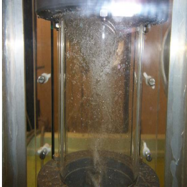
(a) Vortex à bulles , Q_l = 2,85 \text{ m}^3/\text{h} ( V_{s,c,l} = 0,194 \text{ m/s} ), \dot{m}_g = 0 \text{ kg/h} . La bride supérieure se situe à 22 cm environ au-dessous du niveau de l'entrée. La distance entre les deux brides sur la photo est de 15 cm.
