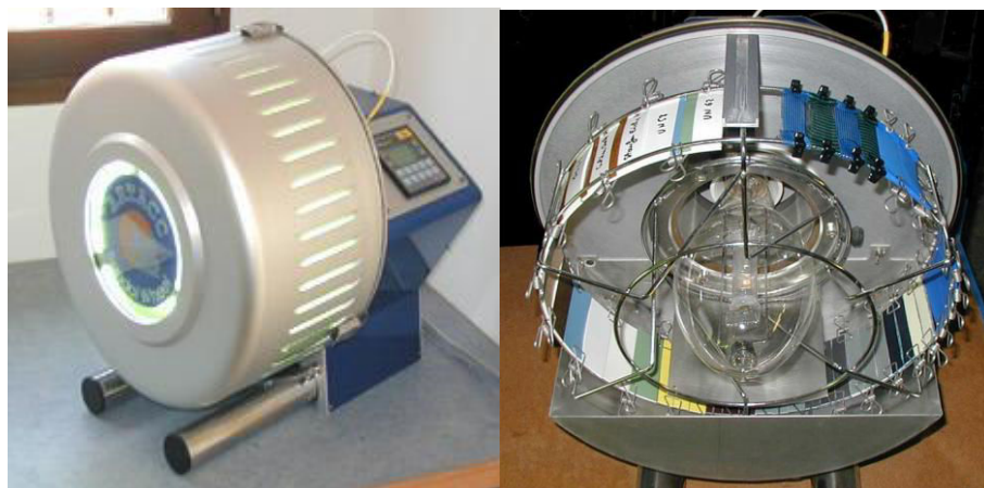
Figure 2-11: Enceinte de photo-vieillissement ARTACC® ( http://www.stationdebandol.com )
