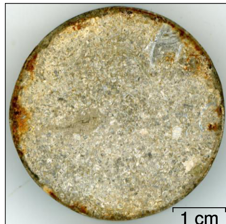
d : Face aval après altération par perméation
