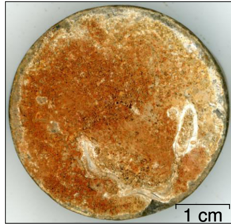
b : Face amont après altération par perméation
