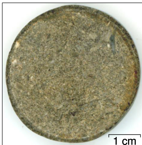
a : Face aval après altération
