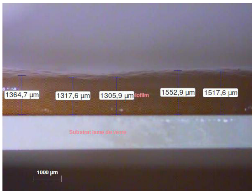
Figure II. 13 La mesure de l'épaisseur du biofilm sur le microscope KL 1500 Stemi SV6 Zeiss.
