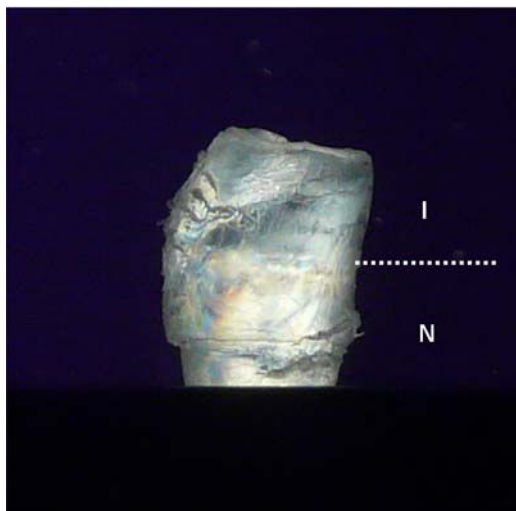
Figure VIII-6. Observation macroscopique entre polariseur et analyseur croisés d'une transition isotrope / nématique photopolymérisée dans un nanocomposite argile/polymère ( \phi = 1.5\% ; R_{A/M} = 1/0.9 ).
