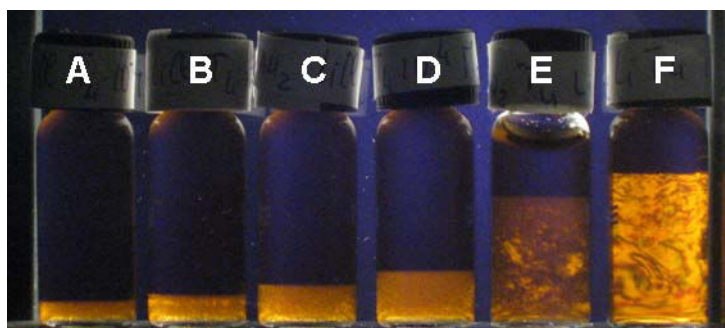
Figure A-3. Observations entre polariseur et analyseur croisés de suspensions de nontronite \text{Li}^+ (taille 4, force ionique : 10^{-4} \text{ M.L}^{-1} ) A. \phi = 0.63\% ; B. \phi = 0.67\% ; C. \phi = 0.70\% ; D. \phi = 0.73\% ; E. \phi = 0.83\% ; F. \phi = 0.93\% .
