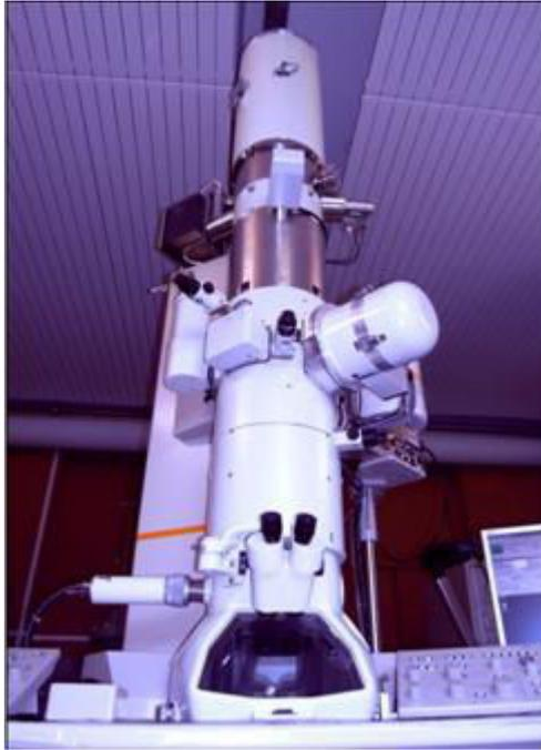
**Figure IV. 6 : Appareil de MET JEOL 2100F**
