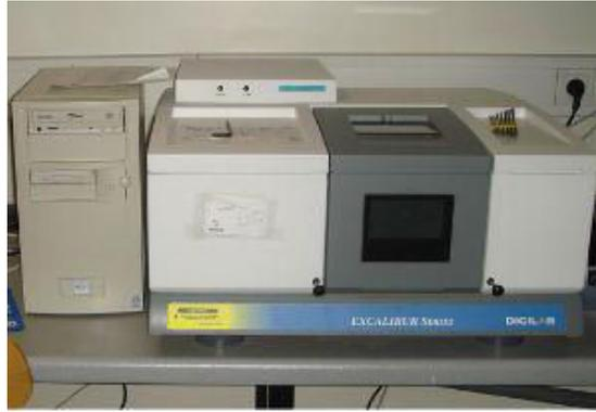
**Figure III. 24 : Spectroscopie IR à transformée de Fourier (Digilab Excalibur 3000)**
