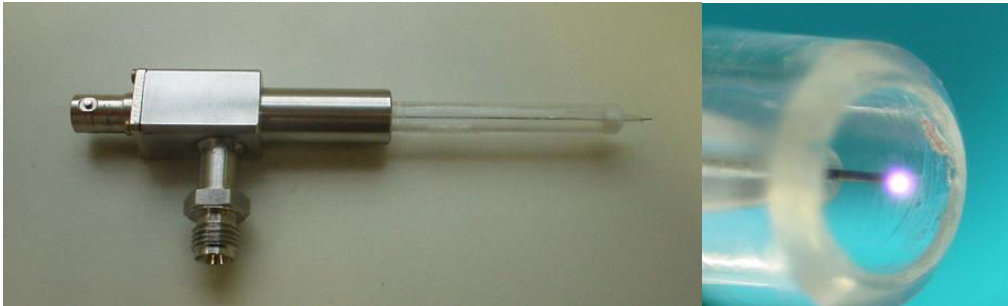
fig. 3 : source plasma utilisée en médecine: (à gauche) le plasma aiguille avec (à droite) la décharge à son extrémité [52].
