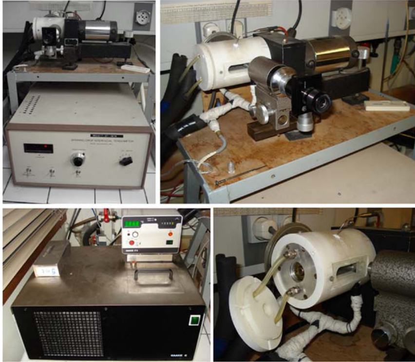
Figure II.4 : Tensiomètre à goutte tournante modifié pour contrôler la température
