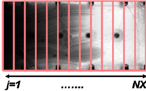
Fig. III.24 : Calcul du profil de la concentration moyenne.
