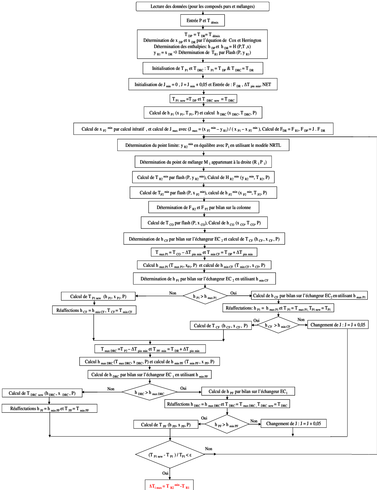
Figure 15. Algorithme de simulation déterminant le saut thermique interne maximal pour le cycle modifié
