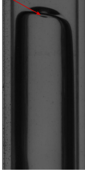
Figure 5.3 – Éclairage LED, D = 20 mm, f = 8 Hz, courbure négative observée par cette technique.
