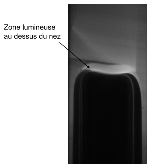
Figure 5.2 – Éclairage laser, D = 20 mm, f = 8 Hz, apparition d'une zone lumineuse au dessus du nez.
