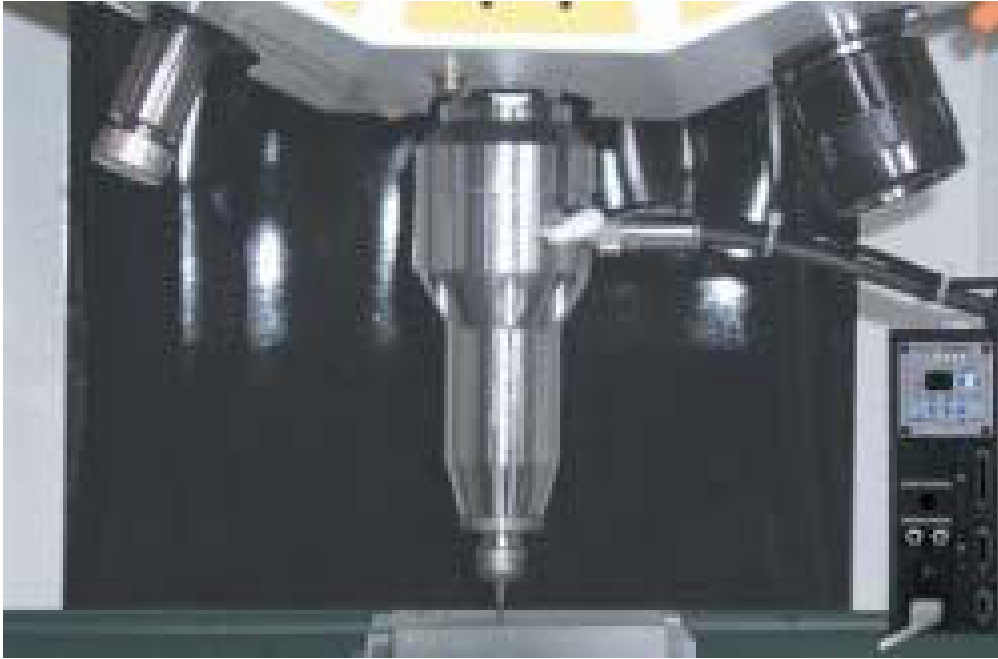
Figure annexe A-5 : Broche d'usinage des micro-canaux HES510 (moteur broche à entraînement direct, ultra précision, haute fréquence), NAKANISHI Inc.
