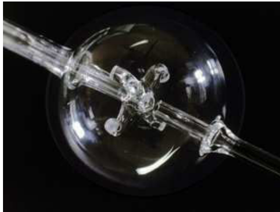
Figure II.10 : Réacteur auto agité par jets gazeux.
