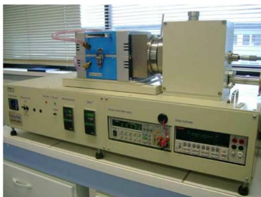
**Figure 11 : Photographie du dispositif de mesure ZEM-3 (Laboratoire CRISMAT de Caen)**
