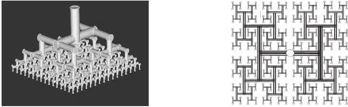
Figure 1.2. Distributeur arborescent pour la distribution du fluide à travers un réseau de microcanaux (perspective 3D et vue de dessus).
