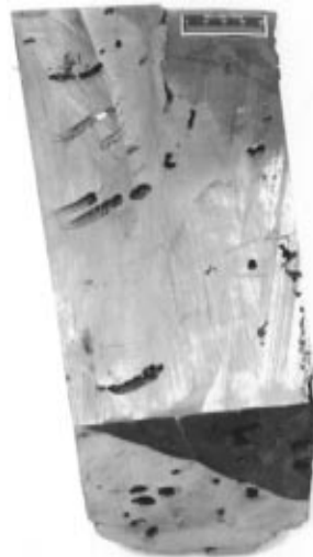
Figure I - 3 - Billette d'alliage Fe-Al élaborée à l'air libre [SIK2005].
