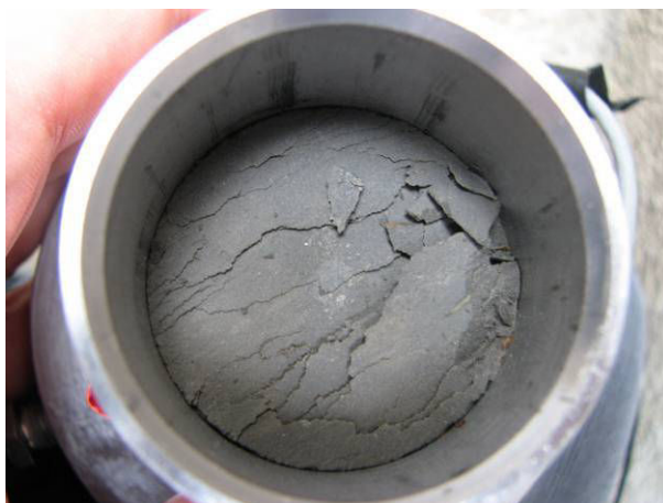
Figure 4.11 : Fracturation superficielle de l'échantillon ANDRA EST 26485
