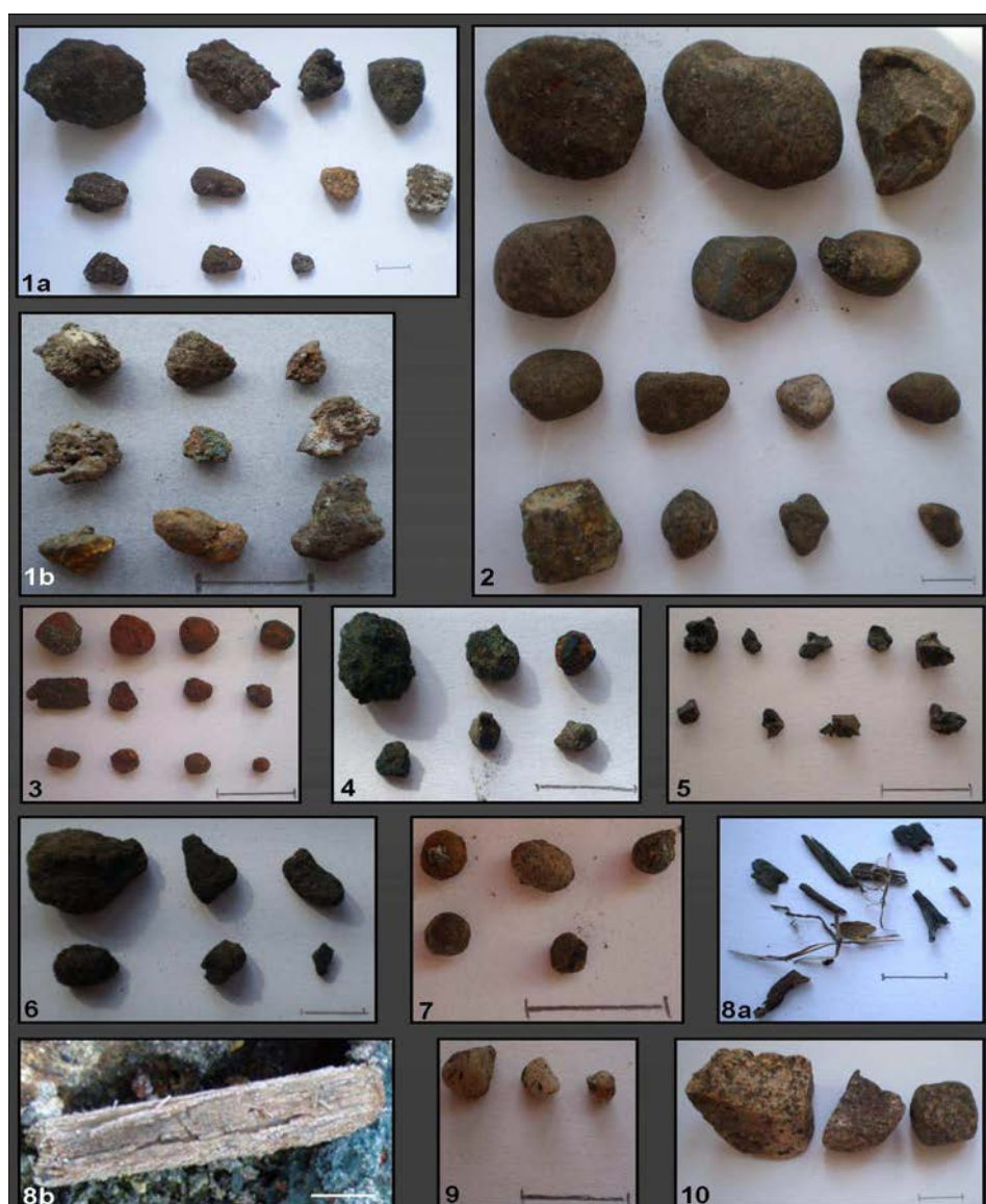
Figure 23 : Observations du refus (fraction >2 mm) (T-1). Le trait représenté sur chaque photo correspond à une échelle de 1 cm.
