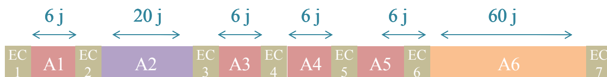
Figure V.17 : Cycles d'écoulement/séchage en mini-lysimètre
