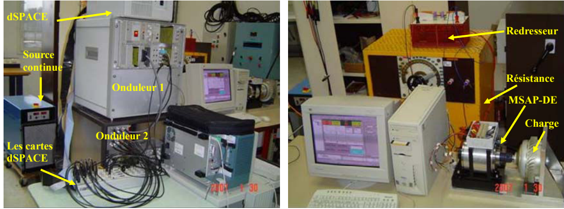
(a) : Schéma de montage expérimental, (b) : la partie de la MSAP et charge.
