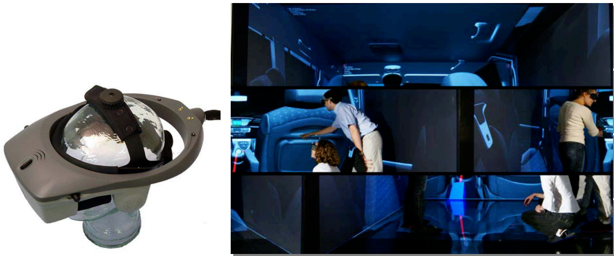
Figure 25 : Exemple de systèmes d'immersion : A gauche une Visiocasque 47 , à droit CAVE™ de PSA Peugeot Citroën 48 .
