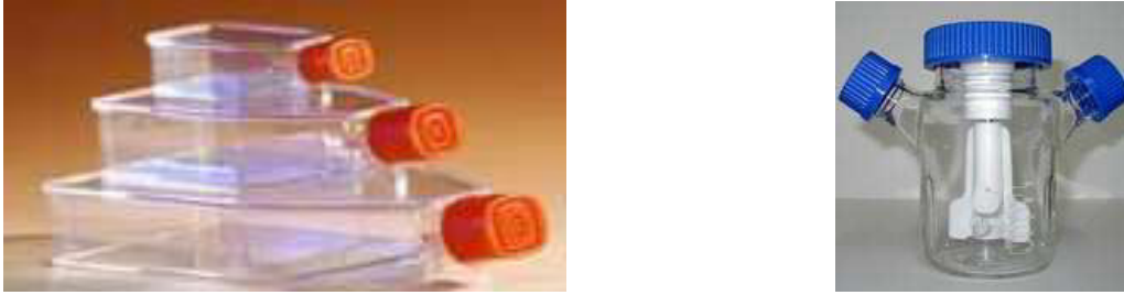
Figure I.12. Exemples de bioréacteurs utilisés en culture cellulaire
