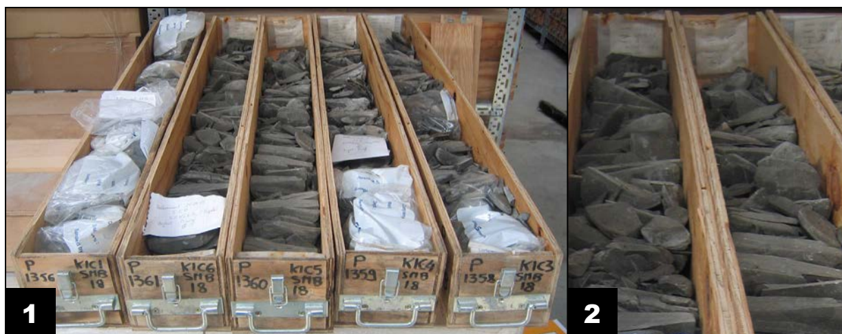
Figure IV.7 : Photographie des carottes d'où sont issus les échantillons SMB18-1, SMB18-2 et SMB18-3 (1). L'état de conservation des carottes est médiocre (2), on peut observer la déstructuration des échantillons suite à une longue exposition aux intempéries.
