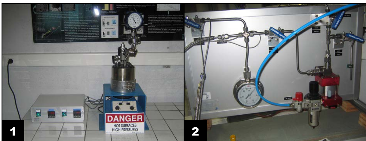
Figure V.29 : Photographies de l'autoclave Parr Instrument ® avec sa station de régulation (1) et de la pompe d'injection de CO 2 (2).
