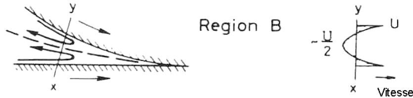
Figure I.19. Description des phénomènes aérodynamiques à proximité du point de contact sol - roue avec un sol mobile et une roue en rotation
