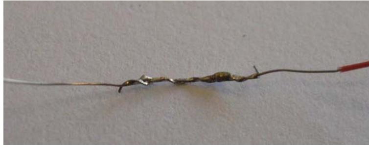
FIG. 3.11 – Soudure d'un thermocouple
