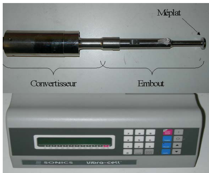
Figure 4.91 : Injecteur ultrasonique et son alimentation
