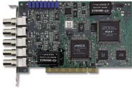
Figure 4.19 : La carte d'acquisition PCI 9812
