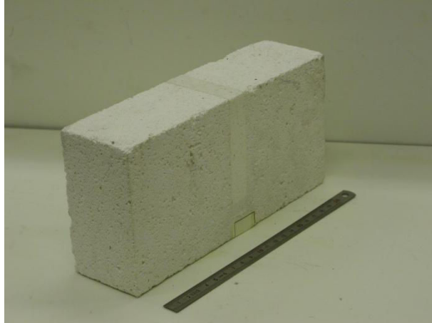
Fig. 13 : Photo d'une brique isolante à 77% d'alumine dont la température limite d'utilisation est 1760°C.
