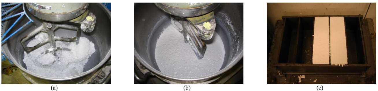
Fig. 29 : Photo de la fabrication des briques (a) béton lors du malaxage ; (b) béton juste avant la coulée ; (c) vue des briques coulées.
