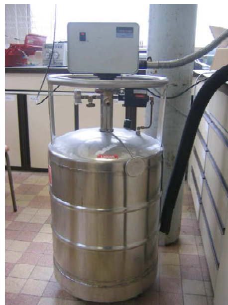
Figure 2.17.b. Groupe de froid Cryofill® permettant une analyse en mode subambiant.
