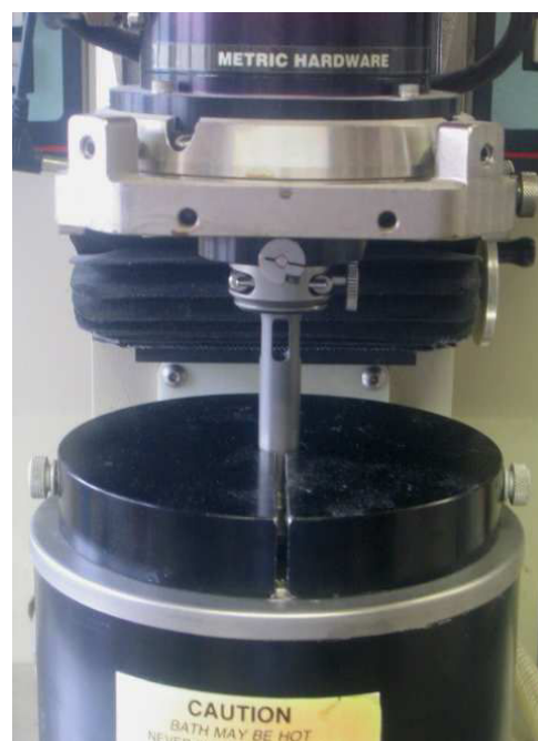
Figure 2.8. Enceinte à solvant permettant de maintenir l'échantillon à l'abri des impuretés et de l'évaporation
