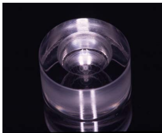
Figure 2.10. Porte-échantillon en forme de demi-sphère ( \varnothing : 10\text{ mm} ; h : 5\text{ mm} )
