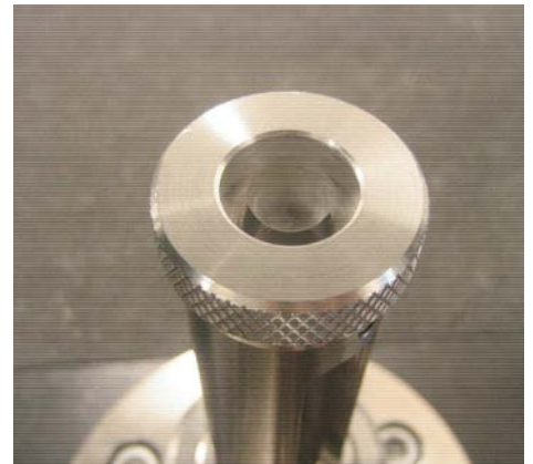
Figure 2.11. Porte-échantillon encollé, vissé dans son écrou
