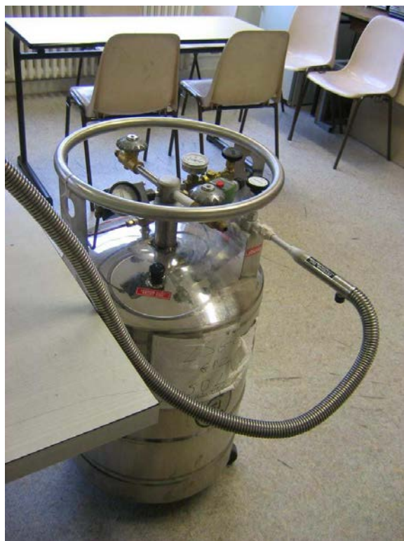
Figure 2.22.b. Groupe de froid en milieu subambiant du DMTA V ®
