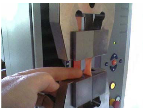
Figure III.10: Éprouvette rectale en phase de relaxation suite à la traction. A ce stade, comme au stade suivant immédiatement la pré-tension, les dimensions de l'éprouvette sont faciles à mesurer par le biais d'un pied à coulisse.
