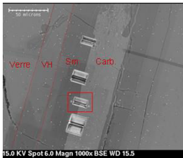
Figure 41 : Microphotographie MEB de la lame préparée par FIB à l'interface smectites (Sm.) / carbonates (Carb.). VH correspond au verre hydraté.
