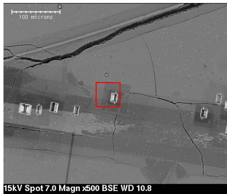
Figure 34 : Microphotographie de la zone de prélèvement des lames FIB.
