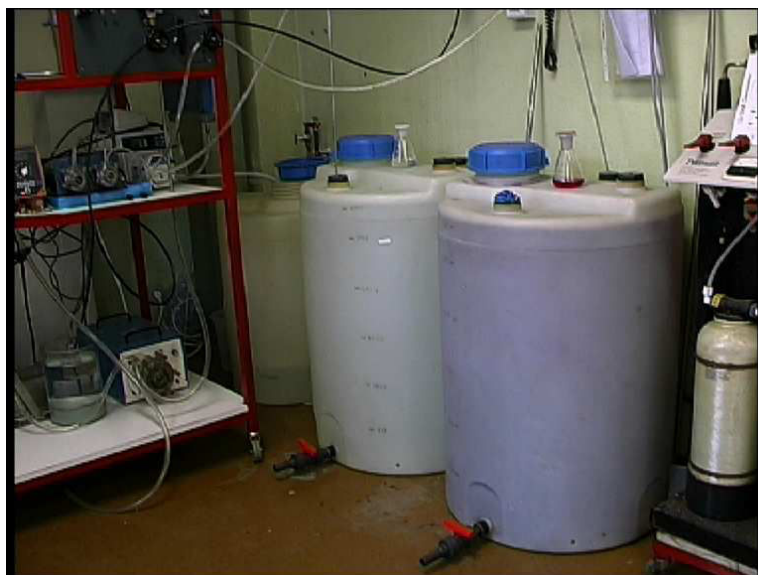
Fig. (IV-14) : Préparation des réactifs A ( H_2SO_4 + phénolphtaléine) et B (NaOH + phénolphtaléine)
