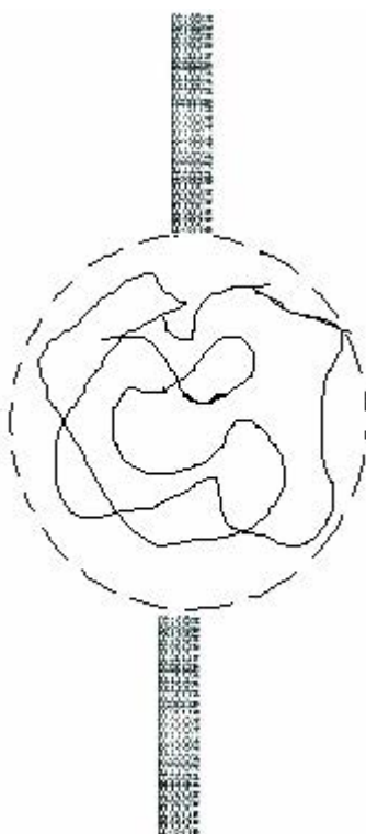
Figure 5.15 : Représentation d'une macromolécule conformée en pelote statistique encadrée par des NTC.
