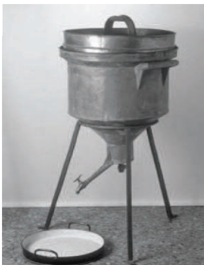
Figure 2.4 : a. Calorimètre original de Lavoisier mis au point en 1780 [82] ; b. Schéma général d'un calorimètre.
