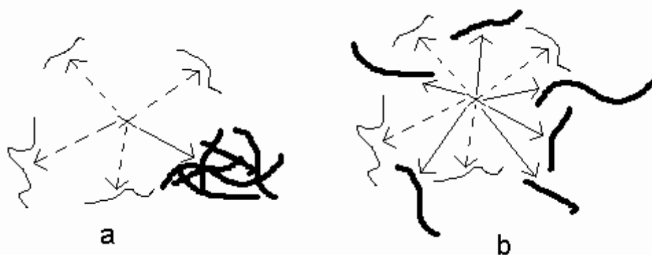
Figure 3.12: Effet de la dispersion des NTC sur le facteur de fréquence. La croix centrale représente un centre actif (catalyseur ou anion). Les lignes fines représentent des segments de polymère & les lignes en gras représentent des NTC. Les flèches en pointillés décrivent une collision entre un centre actif et les macromolécules. Les flèches plaines décrivent une collision entre le centre actif et les NTC (ou agrégats de NTC).
