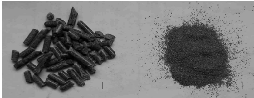
Figure 3-1 : Photographie des granulés de bois avant (a) et après (b) broyage
