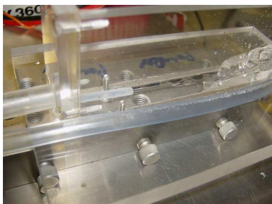
Figure II.15 Test de la longueur de la colonne d'eau en sortie de l'embout en fonction du débit.
