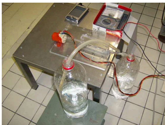
Figure II.14 Montage expérimental servant à estimer le débit du liquide qui circule dans la cellule de synthèse.
