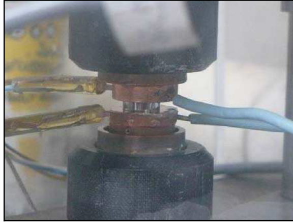
Figure IV.5 Photo montrant l'échantillon placé entre les deux disques de cuivre, eux-mêmes étant maintenus entre deux blocs de cuivre faisant office de source chaude (en haut) et source froide (en bas), les Pt100 pour la mesure de la température et les fils de courant pour la prise de tension.
