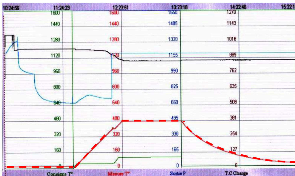
Figure II.30 Diagramme représentant le cycle de chauffe (rouge), de pression (vert) et de pression (bleu) utilisé pour la préparation du matériau de type p \text{Bi}_{0.45}\text{Sb}_{1.55}\text{Te}_3 .
