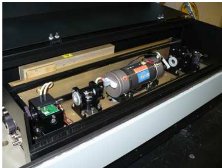
Figure II.8 Photo montrant la cavité résonnante avec la cellule de Pockels.
