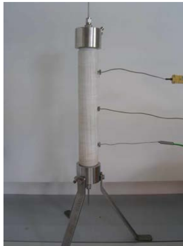
Figure 17: Photo de la troisième cellule d'adsorption
