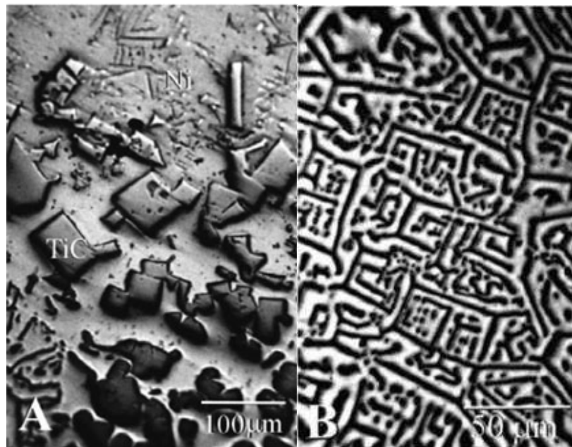
Figure 4-3 Microscopie optique. Microstructure de TiC/Ni solidifié, A : composition pré-eutectique ( C < C_{EX} ), B : composition eutectique ( C = C_{EX} ). D'après [4-3 Strzëciwilk et al. 03].
