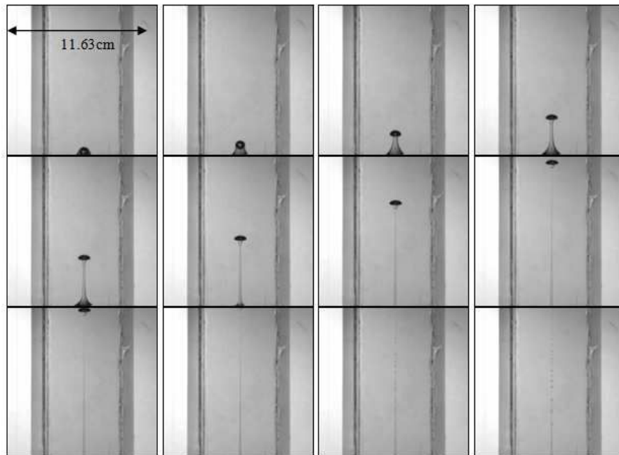
Figure A4.5. Franchissement de l'interface Emkarox 50% massique / huile de silicone 50 par une bulle de 6,4 mm de diamètre équivalent en ascension. Images obtenues par caméra rapide numérique
