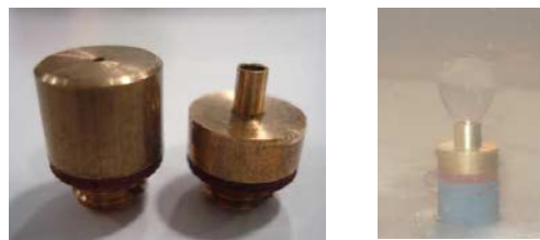
Figure I.02. Différentes formes de buses utilisées : plate et capillaire
