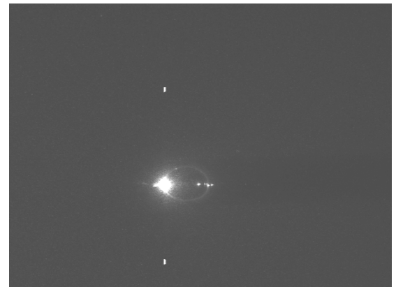
Figure II.36. Champ de vitesse obtenu par PIV d'une bulle en ascension de 200 \times 10^{-9} \text{ m}^3 dans du HV45 65%. Vitesse ascensionnelle de 0,086 m/s. Nombre de Reynolds de 1,05.
