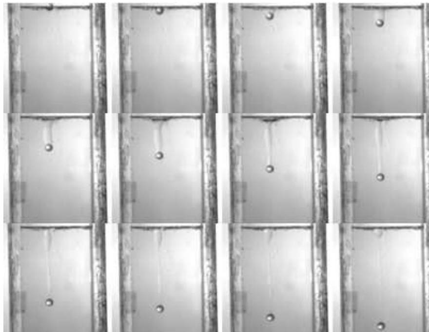
Figure A4.6. Franchissement de l'interface Emkarox 50% massique / huile de silicone 100 par une sphère 4 mm de diamètre en sédimentation. Images obtenues par caméra rapide numérique
