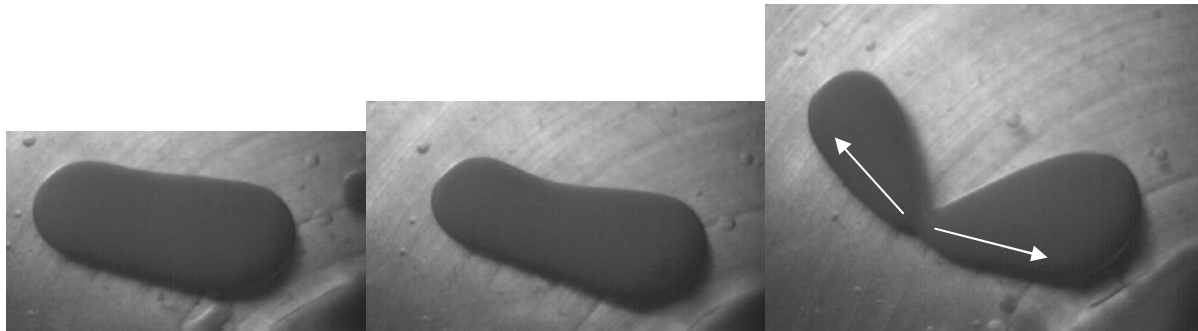
Figure III.37 : Déformation d'une goutte de PAAm 1,25 % dans de l'huile de silicone HS50
