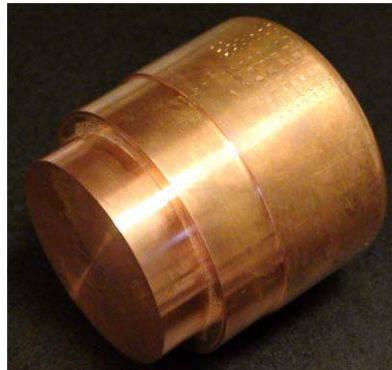
Figure 27 : Éprouvette de cuivre CuC 2 utilisée lors de la première étape.
