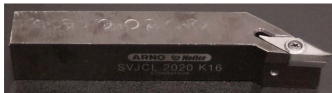
Figure 25 : Outil de tournage (porte-plaquette + plaquette)
