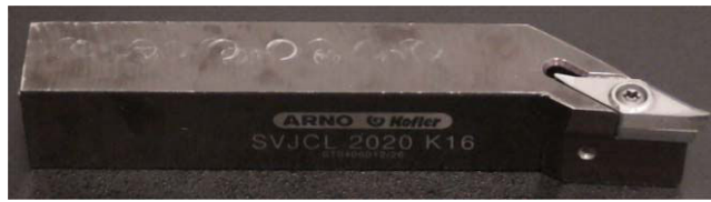
Figure 46 : Outil de tournage (porte-plaquette + plaquette)
