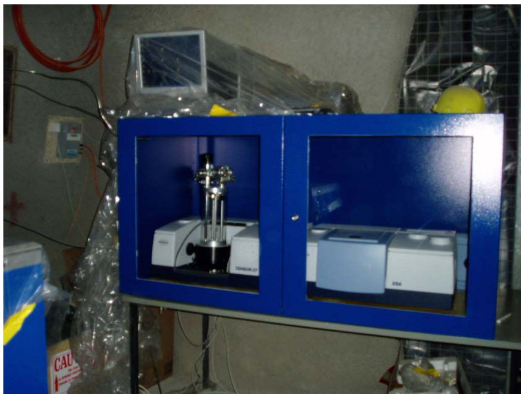
Figure 3.9 : Vue du capteur IR en ligne installé dans un caisson de protection au laboratoire du Mont Terri (expérience PC-C).
