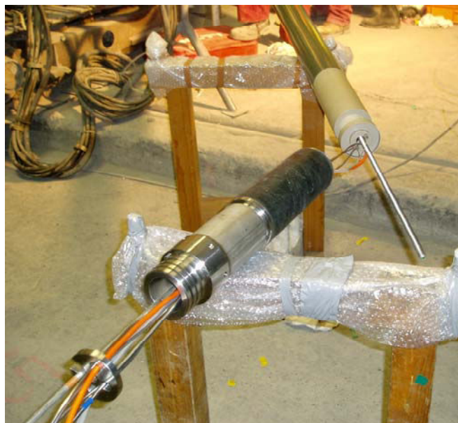
Figure 3.4 : Vue du cylindre creux contenant les lignes du forage (PC-C – Mont Terri).
