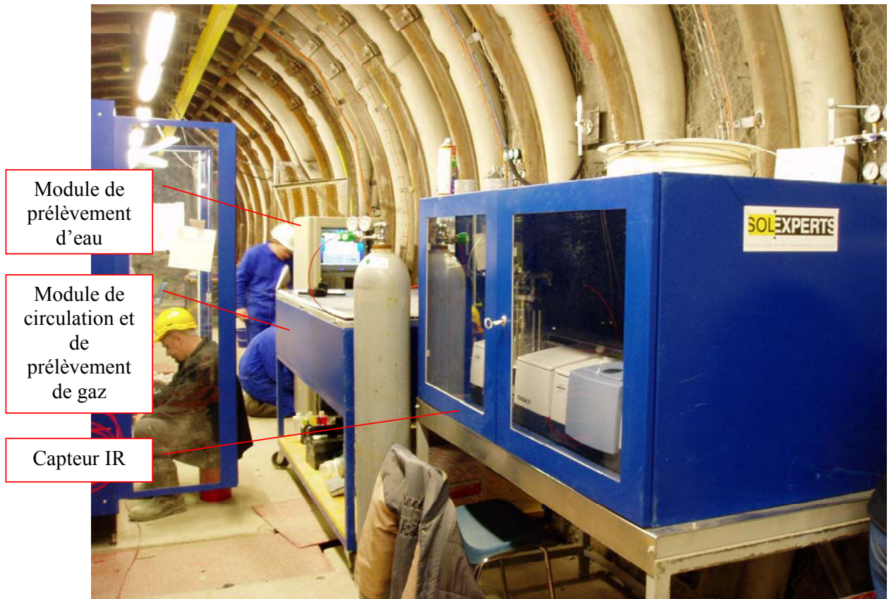
Figure 3.12 : Vue de la zone dédiée à l'expérience PAC2002 dans la niche d'expérimentation à -445 m du laboratoire souterrain de l'Andra.
