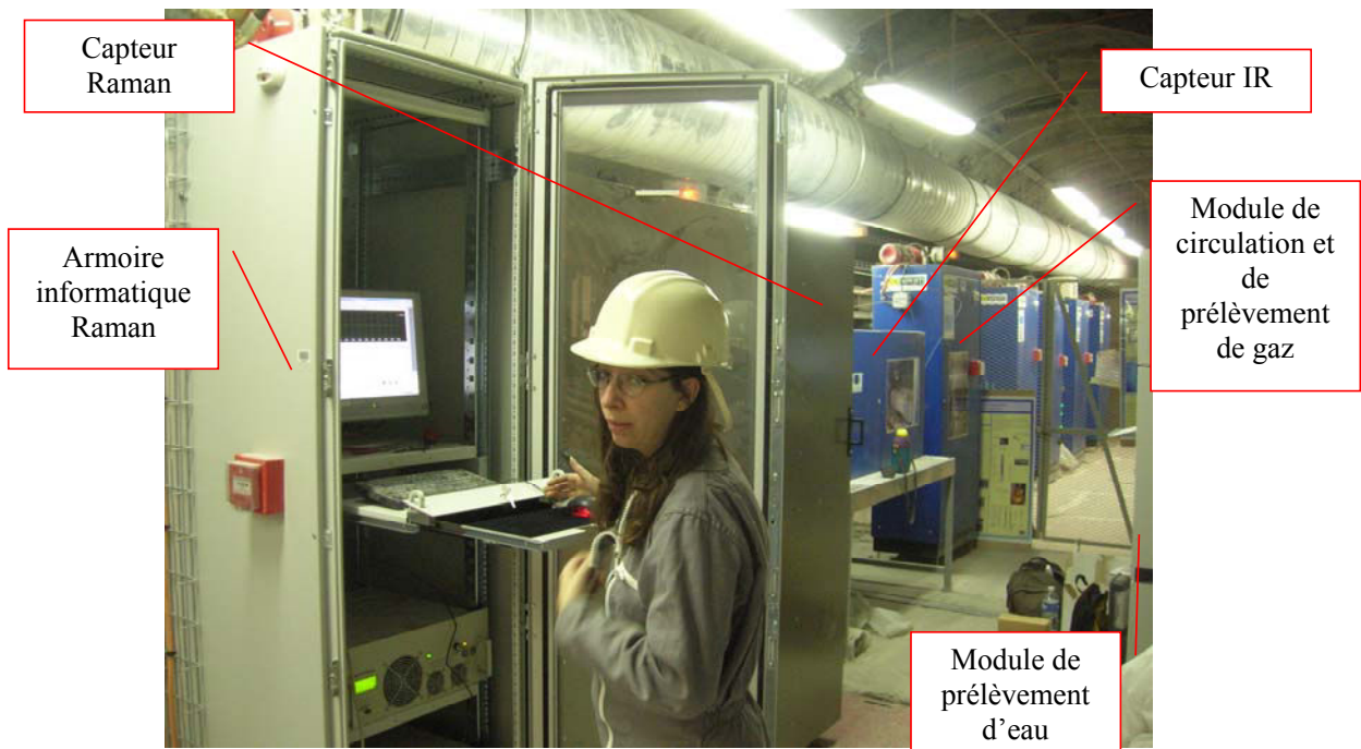
Figure 3.13 : Vue de la zone dédiée à l'expérience PAC1002 dans galerie 5C au niveau principal (-490 m) du laboratoire souterrain de l'Andra.
