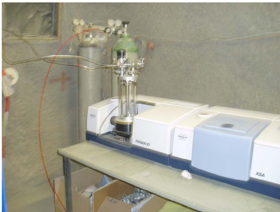
Figure 3.8 : Vue du capteur IR en ligne développé dans cette étude dans son environnement du laboratoire du Mont Terri (expérience PC-C).
