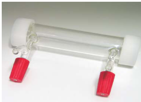
Figure 1.7 : Photo d'un exemple de cellule à gaz à chemin optique court (20cm) : Cellule à gaz A132 Bruker (www.bruker.com). Les fenêtres d'entrée et sortie du rayonnement infrarouge sont aux extrémités du cylindre de verre. Les orifices destinés à l'introduction et à la purge des échantillons (en rouge sur la photo) ne se trouvent pas dans l'axe du trajet optique.
