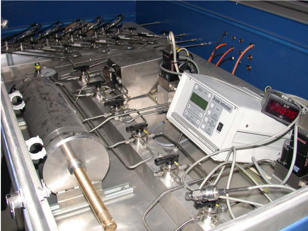
Figure 3.7 : Vue du module de circulation de gaz de l'expérience PC-C au laboratoire du Mont Terri.
