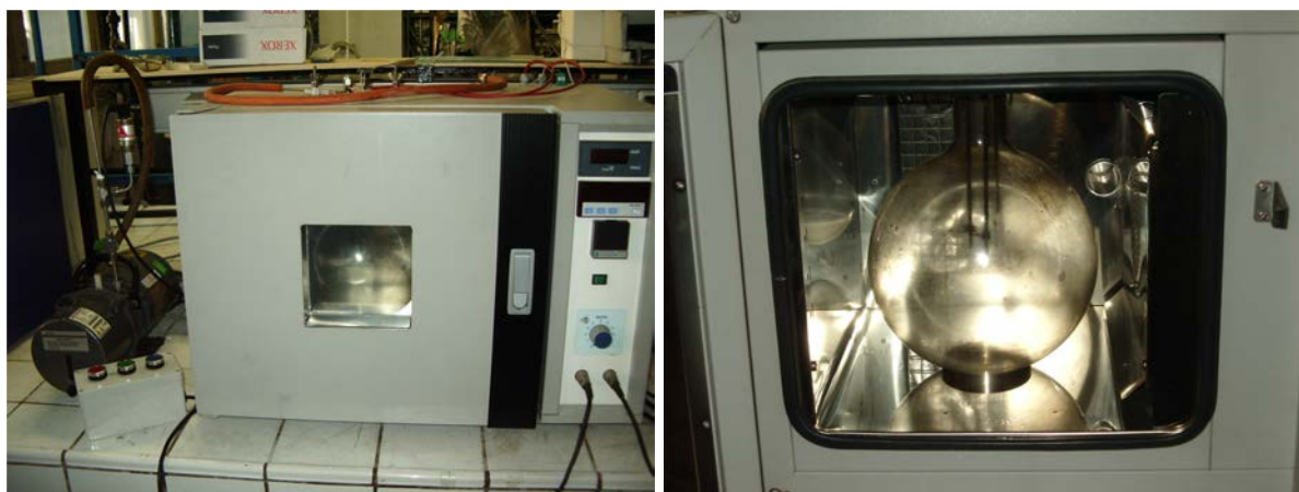
Figure A6-1 : Photographie de l'appareillage de détermination de l'inflammabilité des gaz et vapeurs-Chilworth Technology Ltd.
