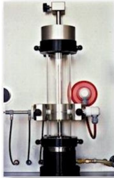
Figure I-9. Schéma et photographie du tube de Hartmann modifié.
