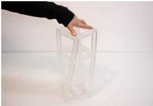
Maquette d'étude pour un banc-poutre en composites souples. Luc Boulais, architecte. (document fourni par l'architecte)
