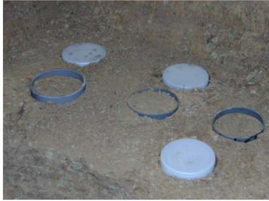
Figure III.3. Prélèvement in situ à 0,65 m de profondeur (Champenois)
