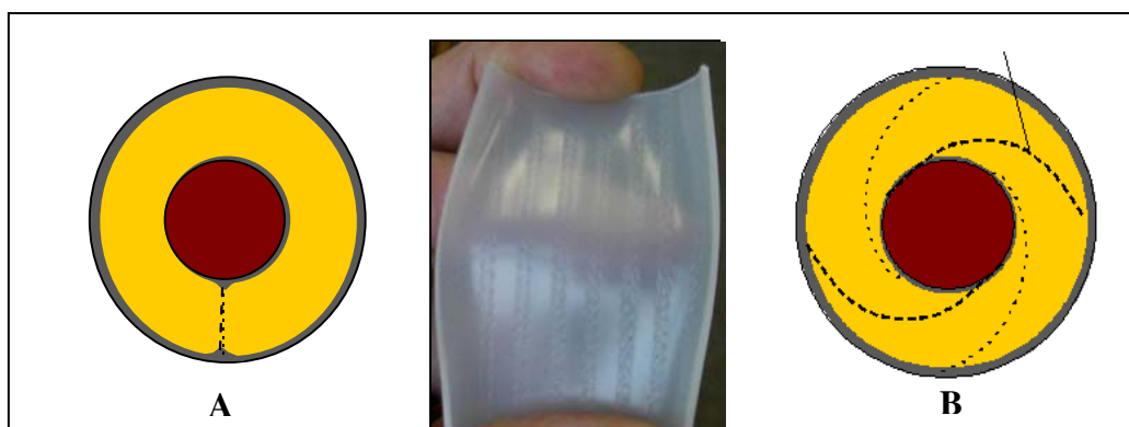
Figure I. 14. Lignes de soudure [SCH00]
