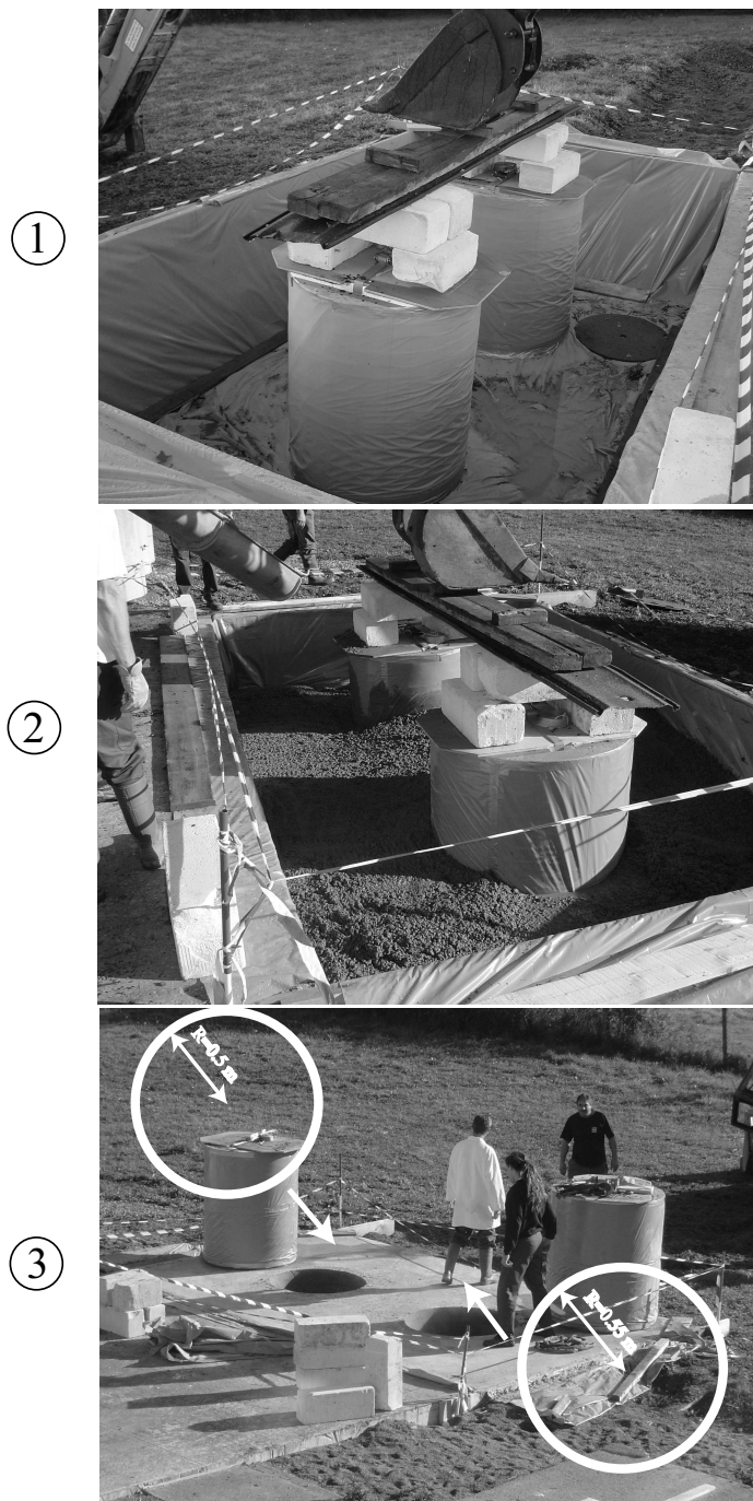
FIG. 6.3 – Photographies du modèle physique contrôlé: ① Fosse avec les moules des cavités cylindriques avant le coulage du béton. ② Mise en place du béton dans la fosse. ③ Modèle physique contrôlée après le retrait des moules et avant la mise en place de la couche «endommagée» (mortier)
